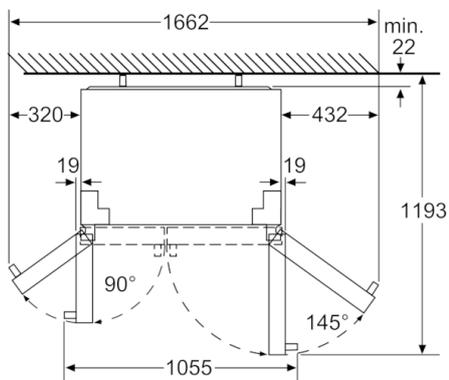
Tiroirs pouvant être entièrement retirés à une ouverture de la porte à 145°.
