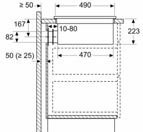
En cas d'installation directement contre des murs extérieurs qui ne sont pas isolés ( $\mu \geq 0,5 \text{ W/m}^2 \cdot ^\circ\text{C}$ ), nous recommandons d'utiliser des configurations de recyclage partiellement ou totalement gainées.
