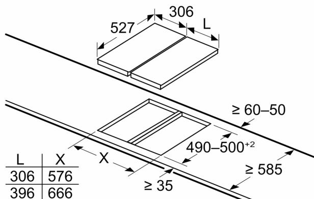
Si deux éléments ou plus sont installés côté à côté, un ou plusieurs kits d'installation sont nécessaires (2 éléments 1 kit d'installation, 3 éléments 2 kits d'installation, etc.)
