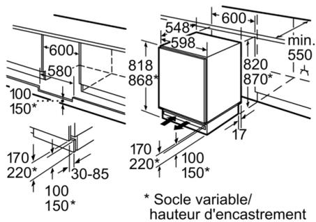
Place pour le raccordement électrique sur le
