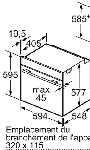
Si l'appareil est installé sur une table de cuisson, les épaisseurs de travail suivantes (le tout compris la sous-structure) doivent être respectées.
