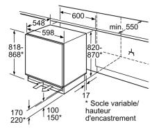
Place pour le raccordement électrique sur le côté à droite ou à gauche à côté de l'appareil. Entrée et sortie d'air dans le socle.
