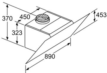
Appareil en mode circulation d'air sans canal
