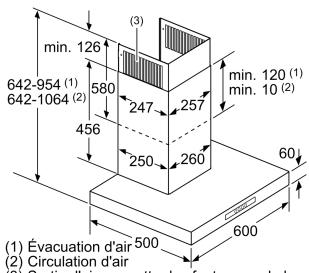
(3) Sortie d'air - remettre les fentes vers le bas lors de l'évacuation d'air
