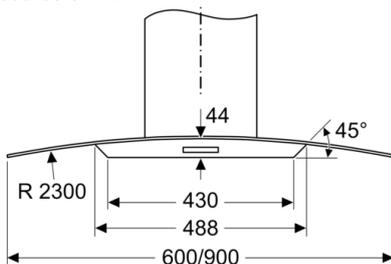
Mesures pour la disposition des panneaux muraux arrière. Veuillez noter que toutes les mesures sont soumises à des tolérances. Les dimensions réelles doivent être vérifiées sur l'appareil existant.
