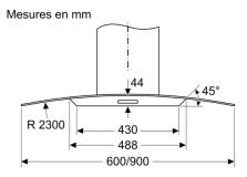
Mesures pour la disposition des panneaux muraux arrière. Veuillez noter que toutes les mesures sont soumises à des tolérances. Les dimensions réelles doivent être vérifiées sur l'appareil existant.
