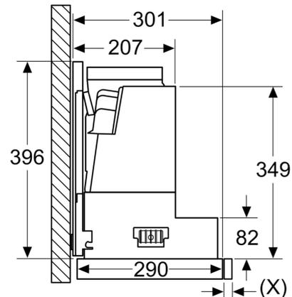
Installer la hotte télescopique avec le kit de suspension – profondeur de l'ossature des éléments de cuisine selon le tableau de combinaisons
