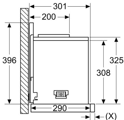
Installer la hotte télescopique avec le kit de suspension – profondeur de l'ossature des éléments de cuisine selon le tableau de combinaisons
