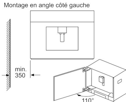
En cas d'utilisation de la limitation de charnière à 92° (réf. pièce détachée 00636455), la distance minimale au mur est uniquement de 100 mm. Mesures en mm
