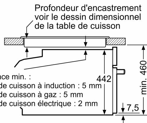
Si l'appareil compact est installé sous une table de cuisson, les épaisseurs de plaque de travail suivantes (le cas échéant y compris la sous-structure) doivent être respectées.
