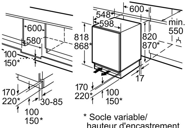
Place pour le raccordement électrique sur le côté à droite ou à gauche à côté de l'appareil.
