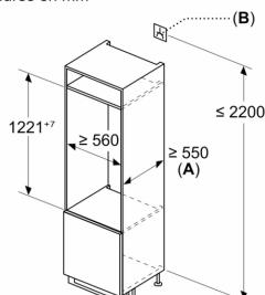
A:  $\geq 560 \text{ mm}$  (recommandé)
