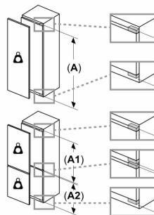
**Poids maximal admissible des façades de l'appareil**
