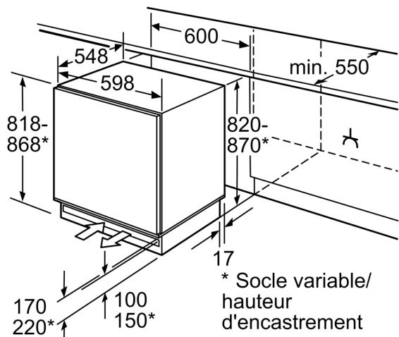
Place pour le raccordement électrique sur le côté à droite ou à gauche à côté de l'appareil.
