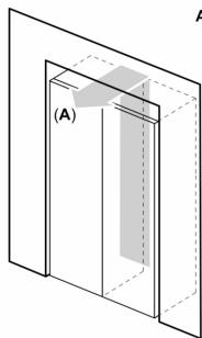
A: Sortie d'air  $\geq 200 \text{ cm}^2$
