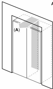
A: Sortie d'air  $\geq 200 \text{ cm}^2$
