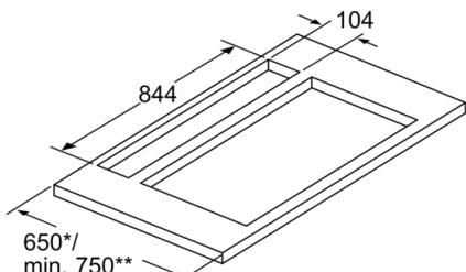
Installer l'appareil d'un seul côté avec une distance d'eau moins 50 mm à côté d'un élément haut ou d'un mur.
