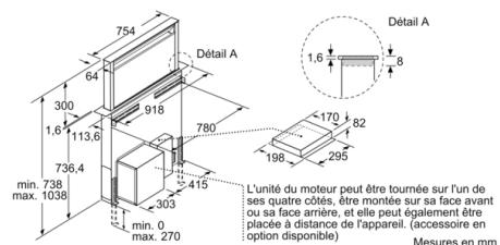
L'unité du moteur peut être tournée sur l'un de ses quatre côtés, être montée sur sa face avant ou sa face arrière, et elle peut également être placée à distance de l'appareil. (accessoire en option disponible)
