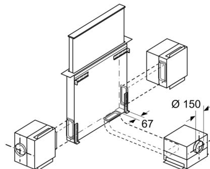
L'unité moteur peut être montée au maximum à 3 m de distance de l'appareil.
