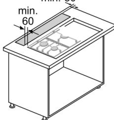
L'utilisation avec une table de cuisson à gaz est uniquement possible avec un système d'aspiration de l'air vicié.
