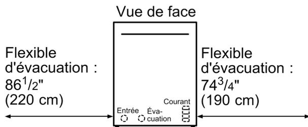
La prise de raccordement électrique et l'entrée d'eau se trouvent à l'avant de l'appareil, l'évacuation se trouve à l'arrière.
