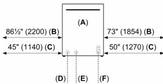
Le câble d'alimentation électrique et les raccordements de vidange sont à l'arrière de l'appareil. L'arrivée est à l'avant. Une rallonge du tuyau de vidange est disponible sous forme d'accessoire. Une boîte de raccordement pour branchement filaire est disponible sous forme d'accessoire.
