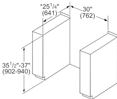
\* En cas d'installation d'îlot avec bandeau d'îlot (HGZIT301), utilisez une profondeur de découpe de  $25\frac{3}{8}$ " (645)
