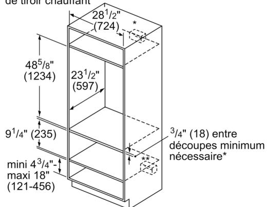
\* Four mural-La prise peut être placée au-dessus ou à droite ou à gauche de l'unité, à proximité de la ligne d'alimentation.
