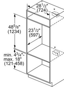
\* Le boîtier de raccordement peut être installé au-dessus, au-dessous, ou à gauche ou à droite de l'unité à portée du caniveau de câbles.
