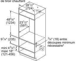
\*Four mural-La prise peut être placée au-dessus ou à droite ou à gauche de l'unité, à proximité de la ligne d'alimentation.
