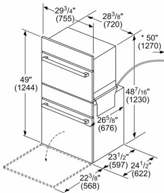
\* Conduit de câbles 50" (1270 mm) du four inférieur
