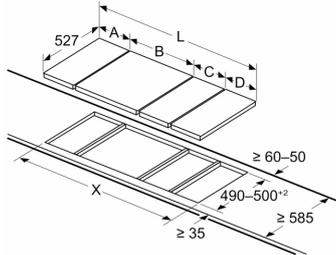
Si deux éléments ou plus sont installés côte à côte, un ou plusieurs kits d'installation sont nécessaires (2 éléments 1 kit d'installation, 3 éléments 2 kits d'installation, etc.)
