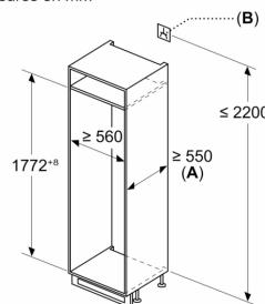
A:  $\geq 560 \text{ mm}$  (recommandé)
