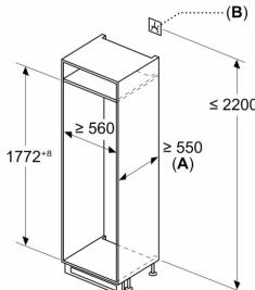
A:  $\geq 560 \text{ mm}$  (recommandé)
