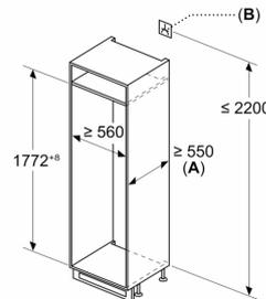
A:  $\geq 560 \text{ mm}$  (recommandé)
