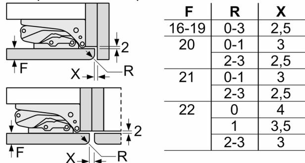
Les dimensions d'espace libre recommandées dans le tableau doivent être respectées afin d'assurer une ouverture sans collision des portes de l'appareil, et d'éviter ainsi d'endommager les meubles de cuisine.
