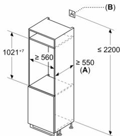
A:  $\geq 560 \text{ mm}$  (recommandé)
