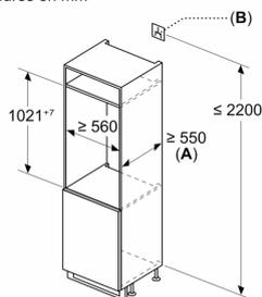
A:  $\geq 560 \text{ mm}$  (recommandé)
