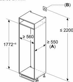
A:  $\geq 560 \text{ mm}$  (recommandé)
