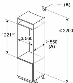
A:  $\geq 560 \text{ mm}$  (recommandé)
