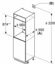
A:  $\geq 560 \text{ mm}$  (recommandé)
