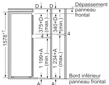
Les dimensions de porte de meuble indiquées sont valables pour un joint de porte de 4 mm. En cas d'utilisation d'une autre largeur de joint (max. 14 mm), les mesures doivent être adaptées.
