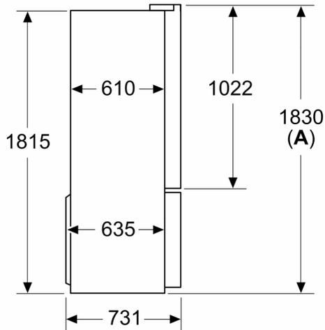
**A:** La façade est réglable de 1830–1847 mm, avec les pieds de nivellement avant à sortie totale
