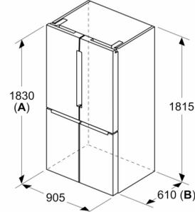
**A:** La façade est réglable de 1830–1847 mm, avec les pieds de nivellement avant à sortie totale
