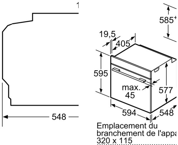
Si l'appareil est installé sur une table de cuisson, les épaisseurs de travail suivantes (le tout compris la sous-structure) doivent être respectées.
