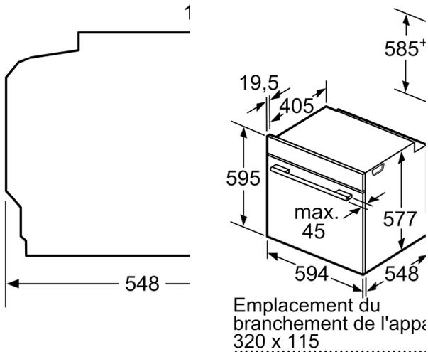
Si l'appareil est installé dans une table de cuisson, les épaisseurs de travail suivantes (le tout compris la sous-structure) doivent être respectées.
