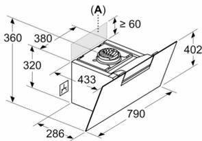
La prise peut être installée sur le côté ou au-dessus de l'appareil
