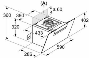
La prise peut être installée sur le côté ou au-dessus de l'appareil
