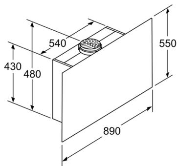
Appareil en mode circulation d'air sans canal
