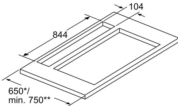
Installer l'appareil d'un seul côté avec une distance d'au moins 50 mm à côté d'un élément haut ou d'un mur.
