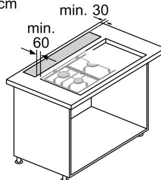
L'utilisation avec une table de cuisson à gaz est uniquement possible avec un système d'aspiration de l'air vicié.
