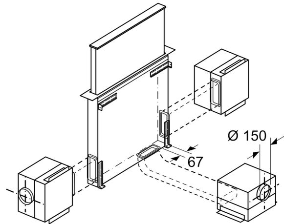
L'unité moteur peut être montée au maximum à 3 m de distance de l'appareil.
