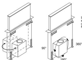
L'unité moteur peut être tournée sur n'importe lequel de ses quatre côtés, et peut être montée sur sa face avant ou arrière.
