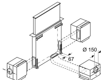
L'unité moteur peut être montée au maximum à 3 m de distance de l'appareil. (Accessoire en option disponible)
