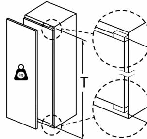
Paigaldatud lubatust suurema kaaluga mööbliuksed võivad hingesid vigastada ja mõjutada nende talitlust.
