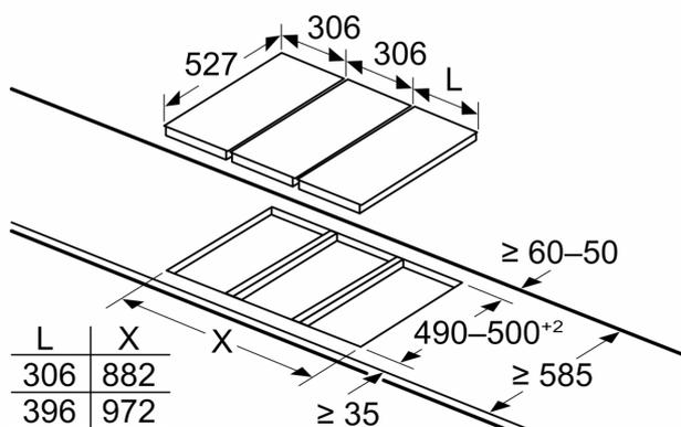
Si se montan dos o más elementos uno al lado del otro, son necesarios uno o varios kits de montaje (para 2 elementos, 1 kit de montaje; para 3 elementos, 2 kits de montaje, etc.)
