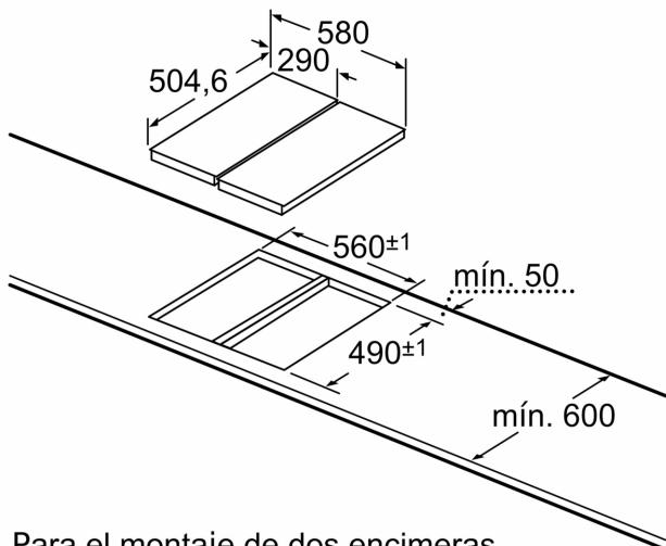
Para el montaje de dos encimeras dominó juntas se requiere un juego de montaje (NEZ 34VLA).
