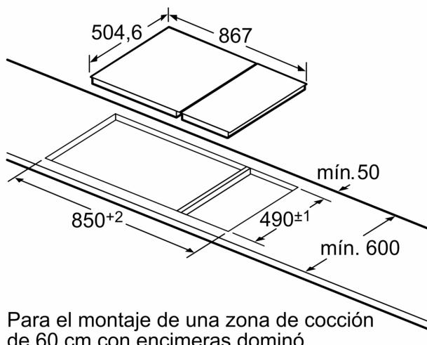
Para el montaje de una zona de cocción de 60 cm con encimeras dominó adosadas- unas a otras es necesario un juego de montaje.
