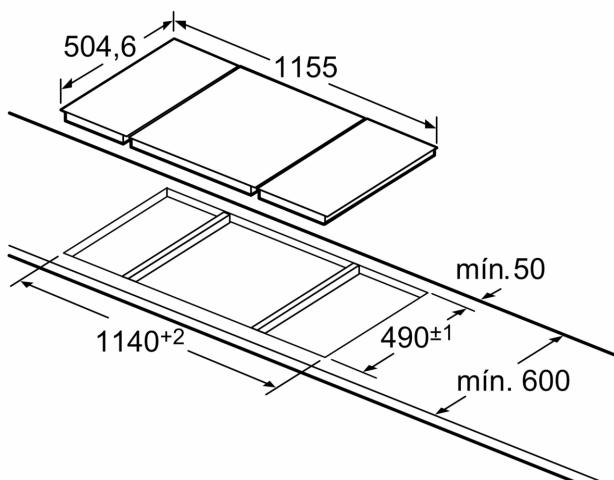
Para el montaje de dos encimeras dominó adosadas a una placa de cocción se requieren dos juegos de montaje.
