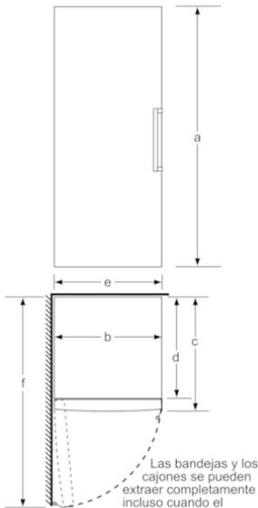
Las bandejas y los cajones se pueden extraer completamente incluso cuando el aparato se encuentra colocado directamente junto a la pared.
