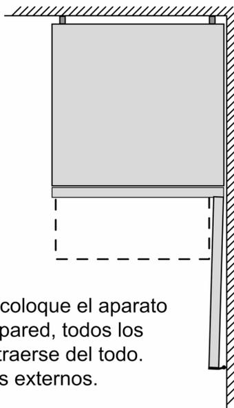
En caso de que se coloque el aparato directamente en la pared, todos los cajones pueden extraerse del todo.
